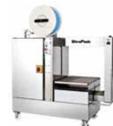
O equipamento de cintar automático de cintagem lateral com arco é usado de forma semiautomática. Possui a cabeça de cintagem lateral de alta velocidade, preparada para ambientes húmidos, com sal e água.
