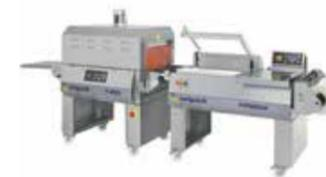
Os modelos da série FP caracterizam-se pela sua estrutura em aço inox (AISI304) e tapete de acordo com as normas CE, relativos aos produtos em contato com os alimentos.
