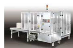
É um equipamento automático que forma e fecha o fundo das caixas com fita auto-adesivo, ficando prontas para o respetivo enchimento. Com 2 carros movidos pneumáticamente, com ventosas para pegar nas caixas fechadas do armazém, realizar a abertura e esquadrar a mesma.
