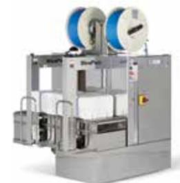
O modelo RQ 7000 MDS é um equipamento de cintar idêntico ao modelo RQ 7000 M, mas com duas cabeças de cintar e dois arcos para permitir cadências mais elevadas. Este equipamento pode ser separado para manutenção e pode ser usado de forma independente como se se tratassem de duas máquinas de cintar individuais.
